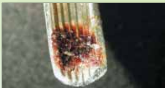
Figure 3. Ce davier a subi un cycle de stérilisation à l'autoclave avant d'avoir été adéquatement nettoyé. La matière organique s'est incrustée dans les sillons de l'instrument. Il faut savoir que l'autoclave (et le Statim) « cuisent » les dépôts organiques, les rendant encore plus tenaces au nettoyage. L'adhérence des prions est alors favorisée.
